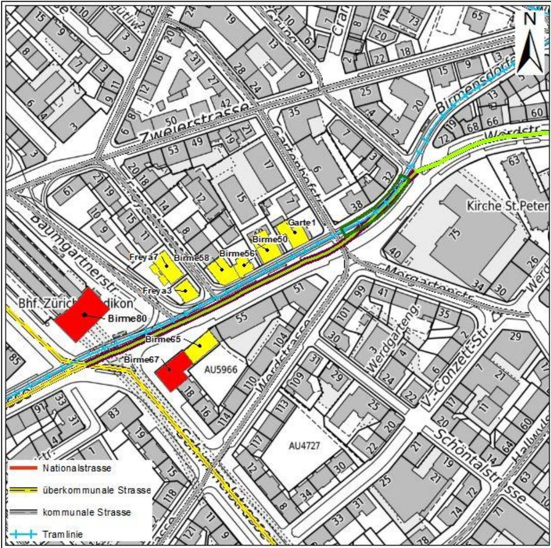
Abb. 8: Gebäude mit Überschreitungen der Belastungsgrenzwerte der LSV auf dem Strassenabschnitt Birmensdorferstrasse (Abschnitt zwischen Schimmelstrasse bis Grüngasse)
